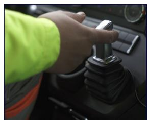
Alarm nepritegnute ručne kočnice.
